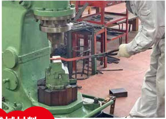
エアハンマーで熱した丸棒を打ちのばし、加工する。
