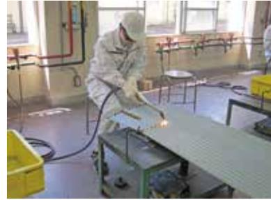
機械材料創造科では1年生の「工業技術基礎」の授業（5月31日発行リポート参照）で電動工具や工具の使い方を学んでいるので上手く使いこなすことができます。ガス切断とはアセチレンガスと高圧酸素を鉄の部に吹き付ける事により鉄を酸化させながら切る方法です。アセチレンガスを使い溶接する方法は1年生で学びますが、溶断は3年生の後半にならないと学ばないので今回は切断に初挑戦です。
